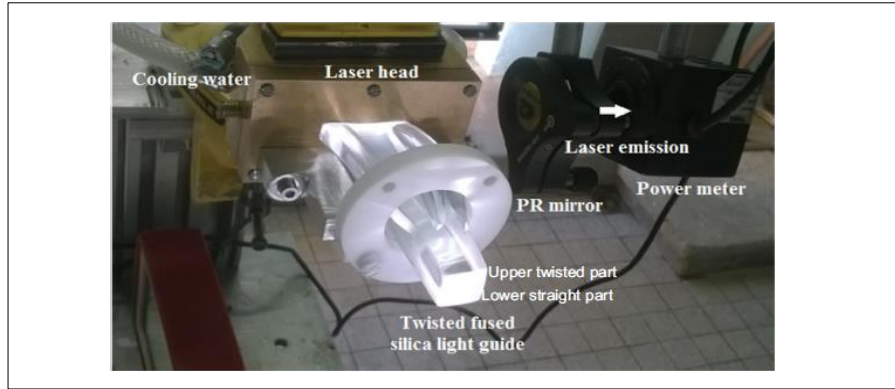
الصورة. 31.3 نظام الليزر الشمسي مع دليل ضوئي ملتوي من السيليكا لاستخراج طاقة الليزر المستقرة TEM 00 [41].
