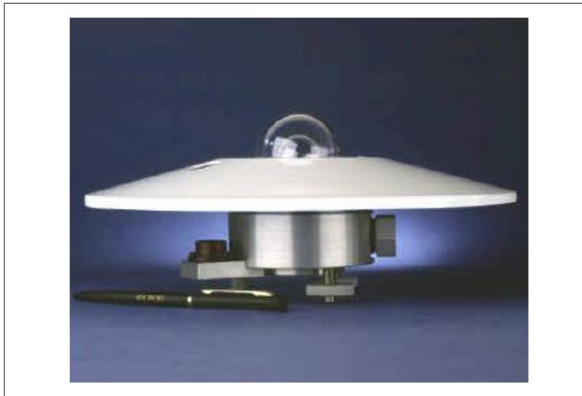
الصورة. 11.2 - جهاز قياس شدة الإشعاع الشمسي المباشر[59].
