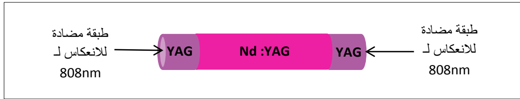
الصورة. 1.4 وسط الليزر مكون من YAG / Nd :YAG / YAG.
