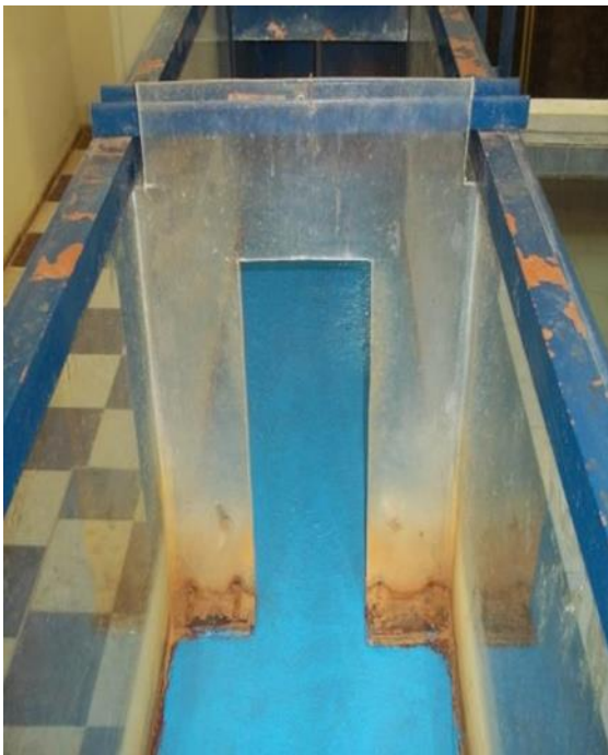
Photo 4.4 : Section de contrôle
