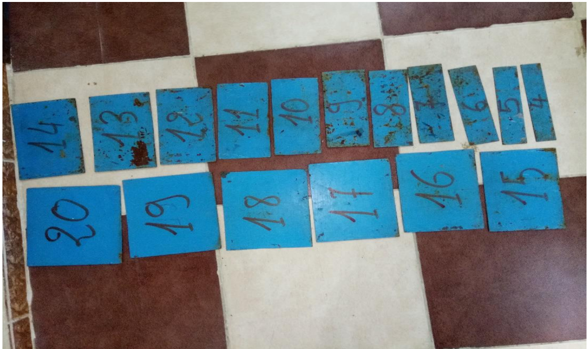
Photo 4.7 : Photographie des seuils minces testés
