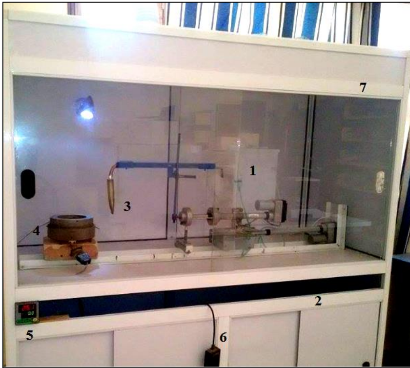
شكل (III 1) التركيب التجريبي المستخدم لتحضير الشرائح ( محلي الصنع )
