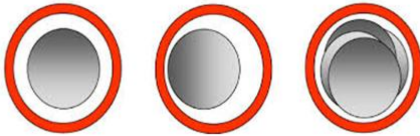
Figure 1.4 Excentricité statique et dynamique
