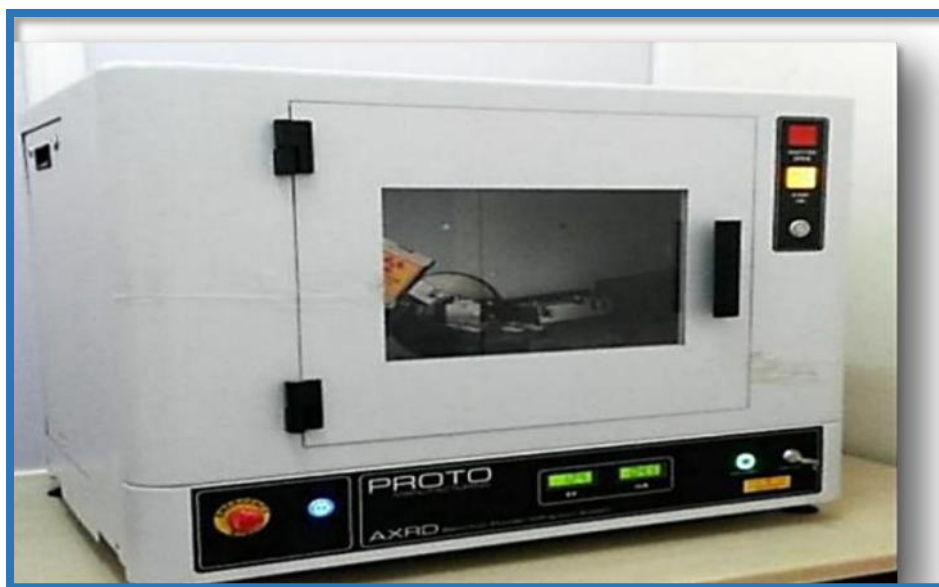
الشكل(II-14): جهاز انعراج الأشعة السينية المستخدم.
