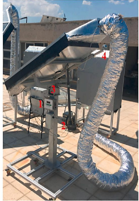
الشكل 20: رسم تخطيطي لتكوين التجربة ونظام التتبع الشمسي -1 (PLC المعالج، 2- المقاومة الهيدروليكية للمحرك، 3- المبادل الحراري للمحرك، 4- صمام. Ldr ( Mehmet Das et al ) [21].
