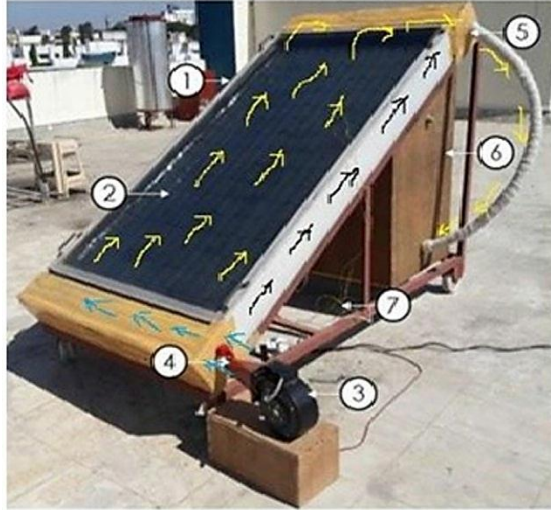
الشكل 16: مجفف الهواء الشمسي بالحمل الحراري القسري غير المباشر [14] (Sunil et al).
