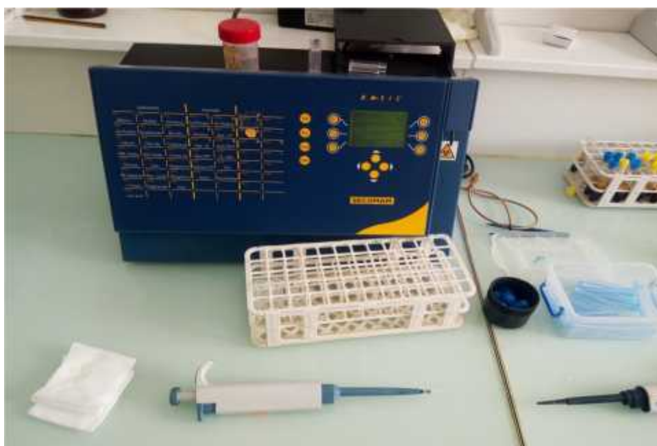
Figure 07: Analyseur biochimique (TGO,TGP,PAL) de type SFRI BCC 3 (photo original., 2018)
