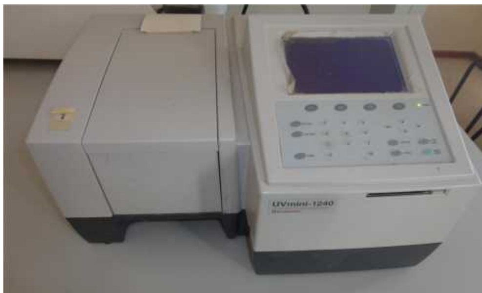
Figure 05: Spectrophotométrie à transmission moléculaire de type UV- VIS -1240 (photo originale., 2018).
