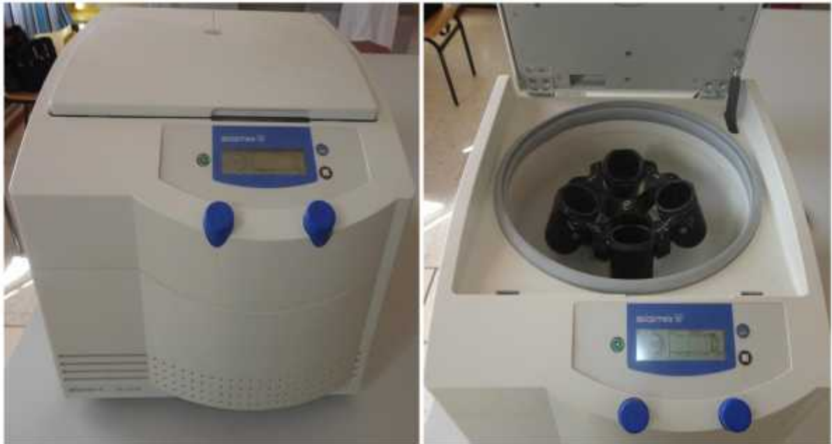
Figure 03: Centrifugeuse horizontale de type SIGMA (photo originale., 2018).
