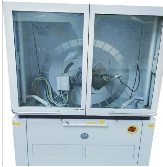
الشكل 3. II جهاز انعراج الأشعة السينية (XRD)
