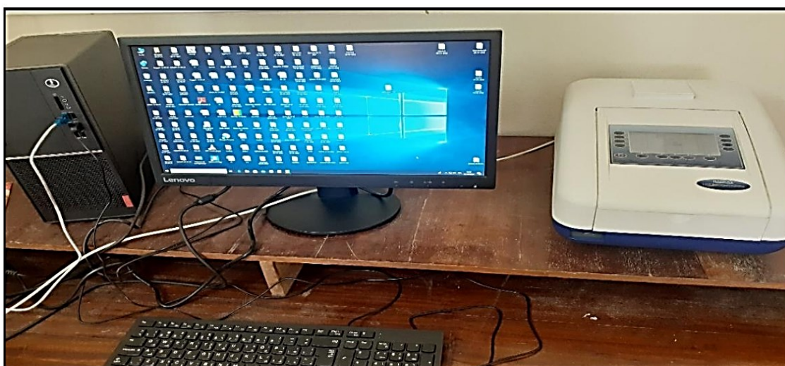
الشكل 6.II جهاز مطيافية الأشعة فوق البنفسجية - المرئية (UV-VIS).
