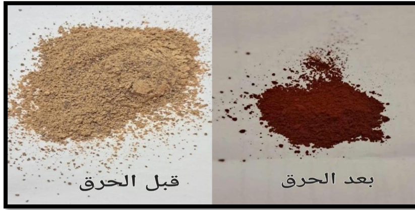
الشكل (4-5): "كبريتات الحديد مع الخميرة قبل وبعد الحرق"
