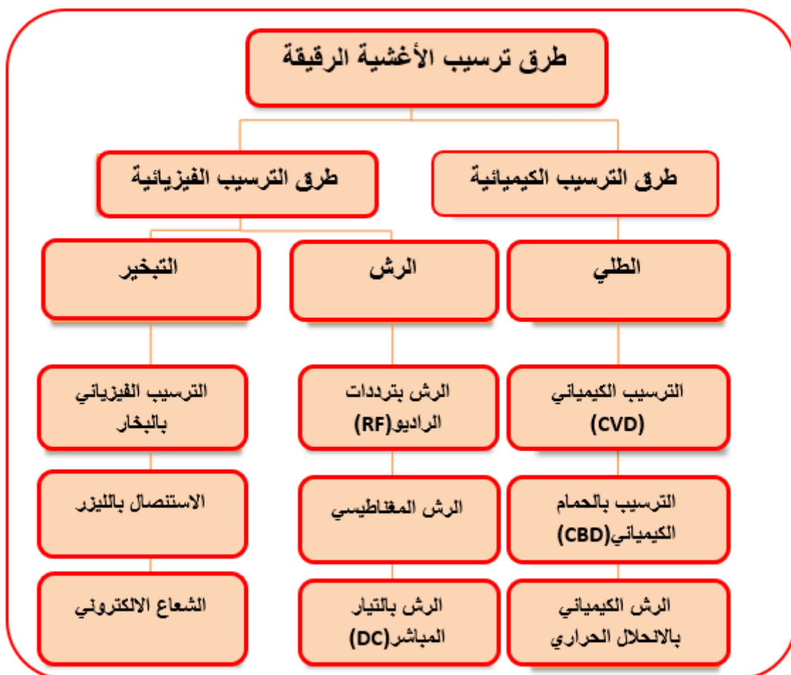
الشكل (10.II): مخطط يوضح التقنيات المختلفة لترسيب الأغشية الرقيقة [37] .
