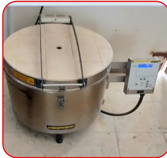
الشكل (5.III): صورة الفرن الكهربائي المستخدم.
