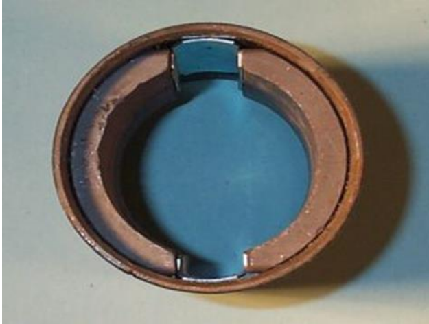
Figure.II.11 : Inducteur à aimants permanents [57]
