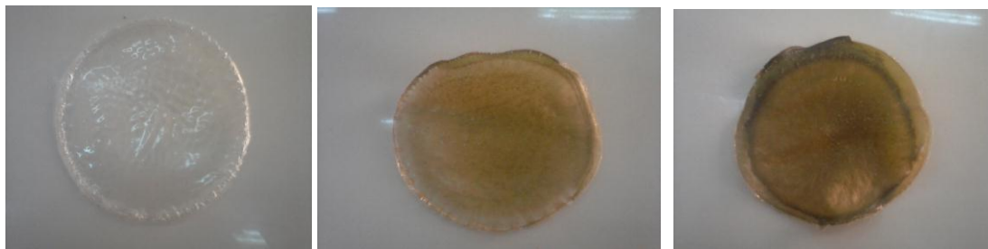
Fig. IV.3: PVC+0g de fibre Fig. IV.4 : PVC+0.2g de fibre Fig. IV.5 :PVC+0.4g de fibre
