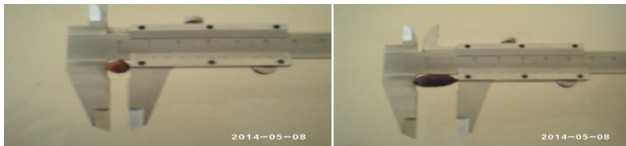
شكل 13: جهاز قياس الطول والقطر(القدم القنوية).
