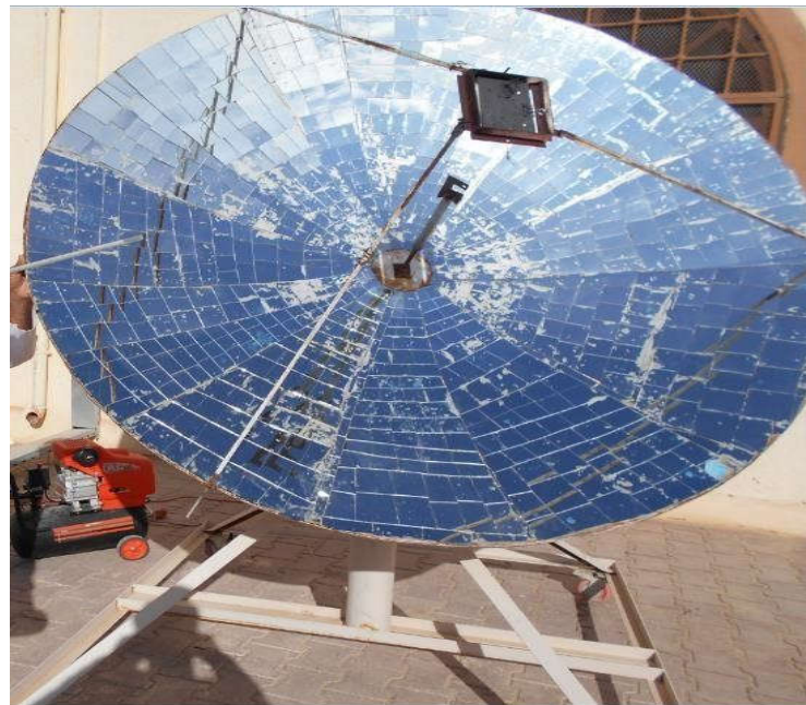
Figure I.5 : Vue générale du concentrateur solaire utilisé (laboratoire22, Université Echahid Hamma Lakhdar, El Oued). [62].
