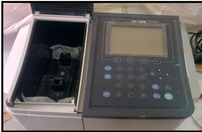
Figure II. 20 : Dispositif expérimental de spectroscopie UV-visible utilisé (laboratoire des matériaux organiques. Université Echahid Hamma Lakhdar).
