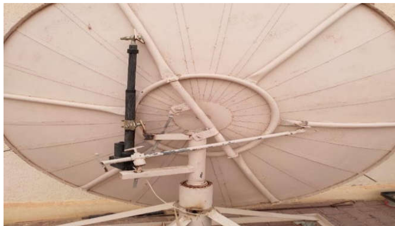
Figure II. 5 : Photo du système de suivi contenant un cylindre et un axe rotatif.
