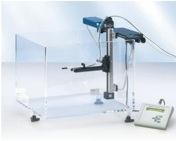
Figure II.1: Fantôme d'eau de PTW [41] Figure II.2 Fantôme équivalent patient en PMMA [41].
