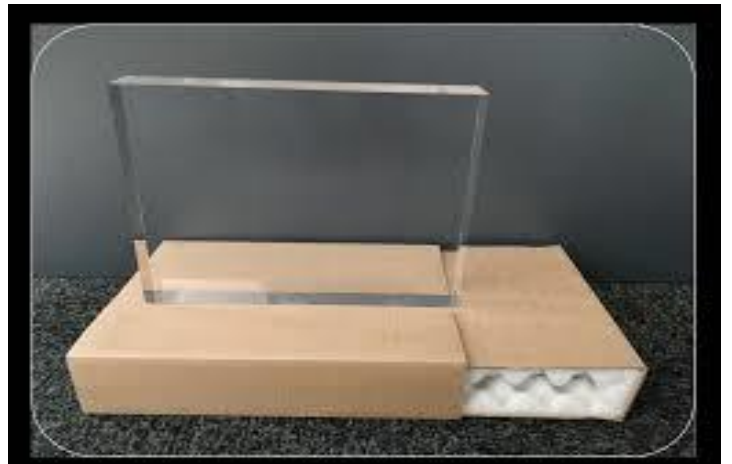
Figure II.1: Fantôme d'eau de PTW [41] Figure II.2 Fantôme équivalent patient en PMMA [41].
