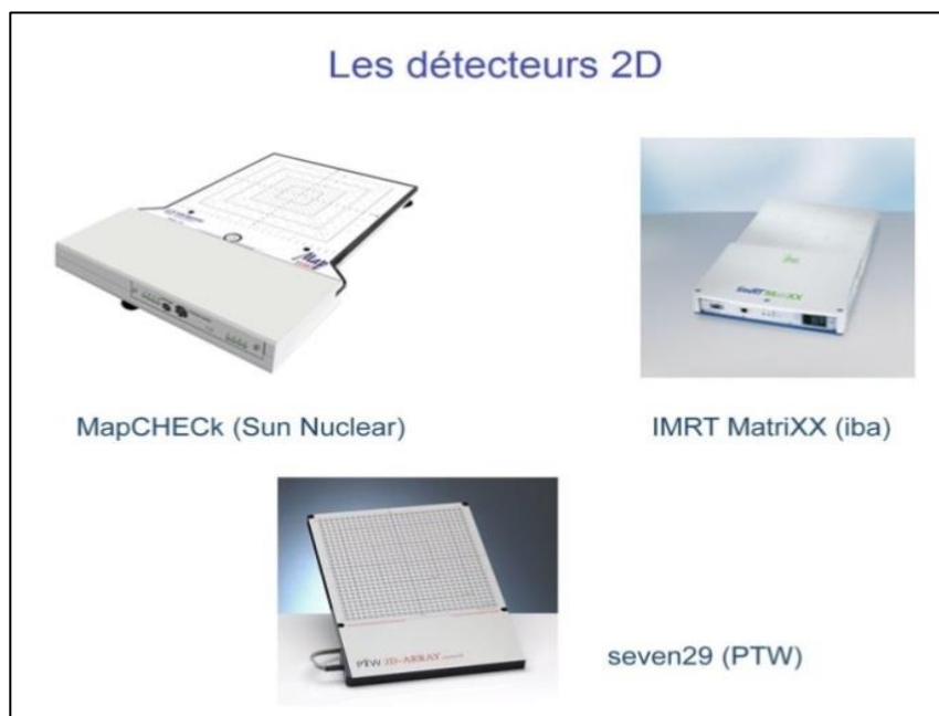
Figure II.4: Les principaux détecteurs 2D [32].
