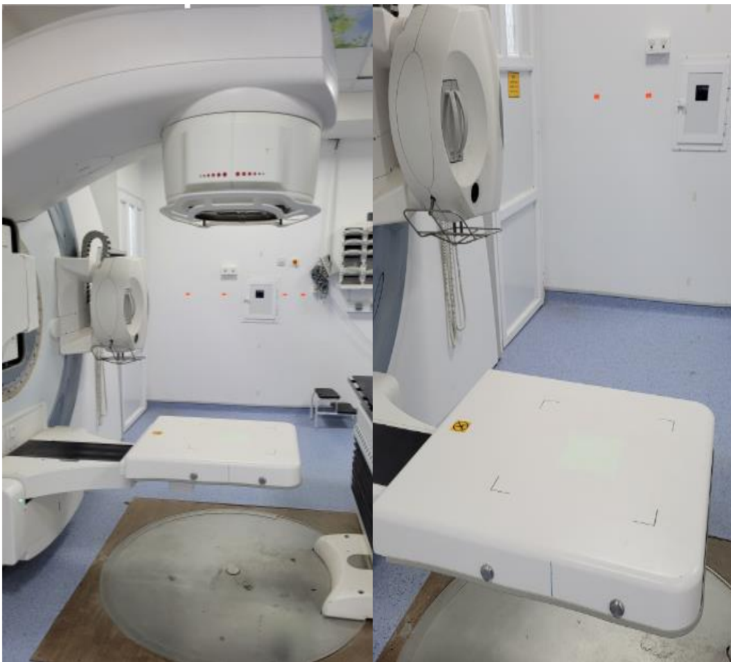
Figure III. 5 : Cette image représente l'EPID de l'accélérateur linéaire Elekta Infinity de CAC
