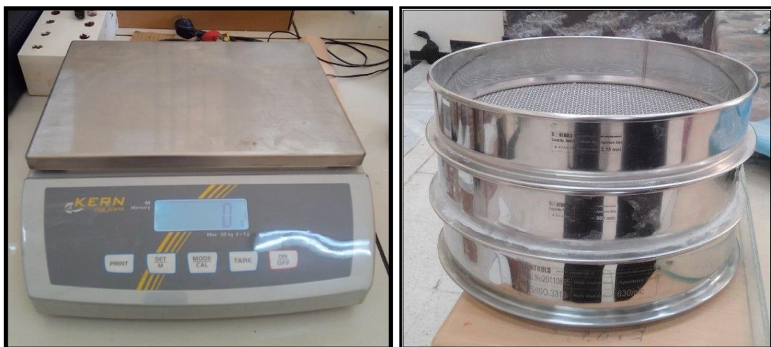
PhotoIII.2: Balance et série de tamis normalisés.
