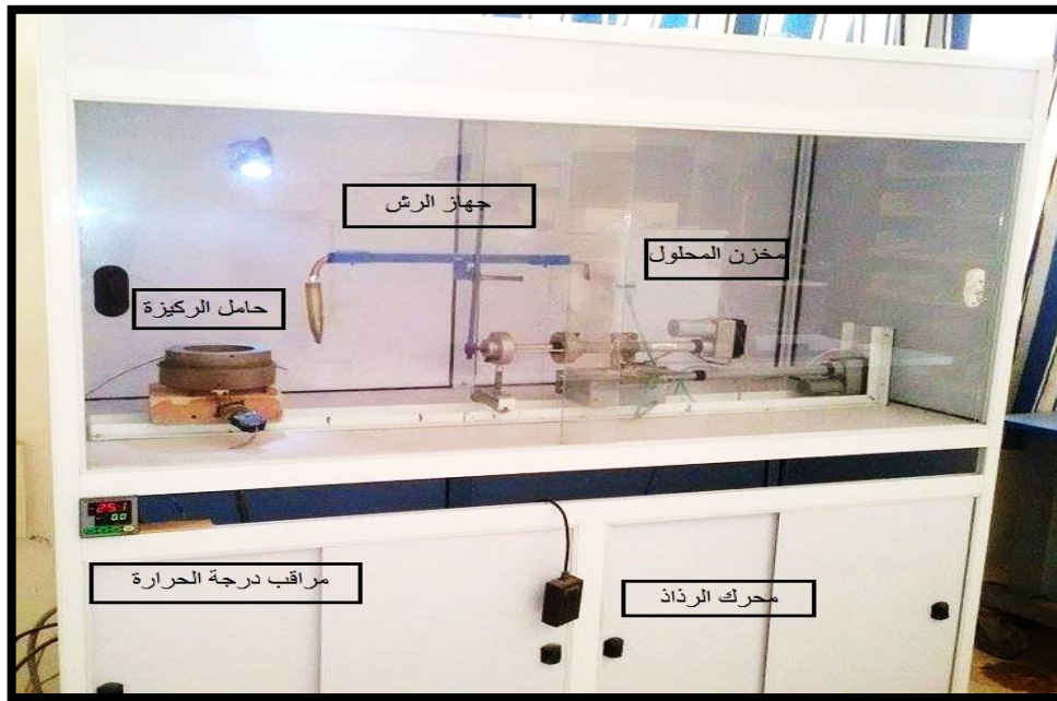
الشكل(III- 1) : التركيب التجريبي لترسيب الأغشية الرقيقة " تقنية التحلل الكيميائي الحراري".
