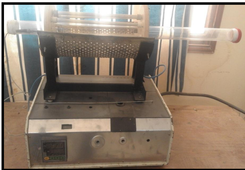
الشكل (III-6): رسم توضيحي يبين جهاز المعالجة الحرارية (صنع محلي).
