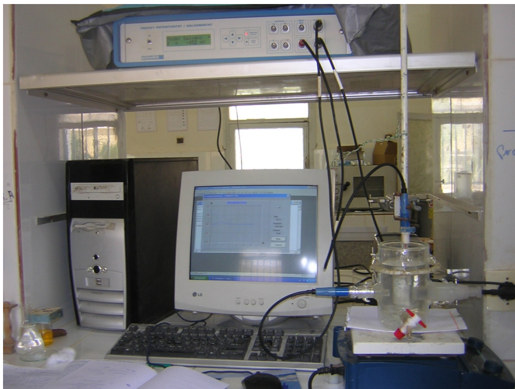
Figure 1: Montage potentiostatique pour mesures électrochimiques
