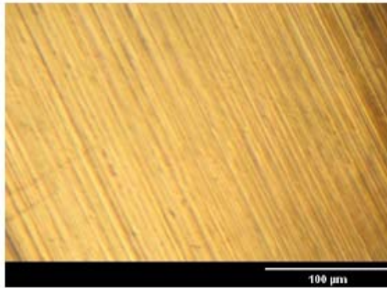
Figure III-7: Micrographie de la surface de l'acier X52 après polissage.
