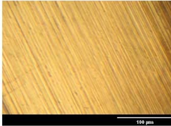
FigureIII-4:Micrographie de la surface de l'acier X52 après polissage.
