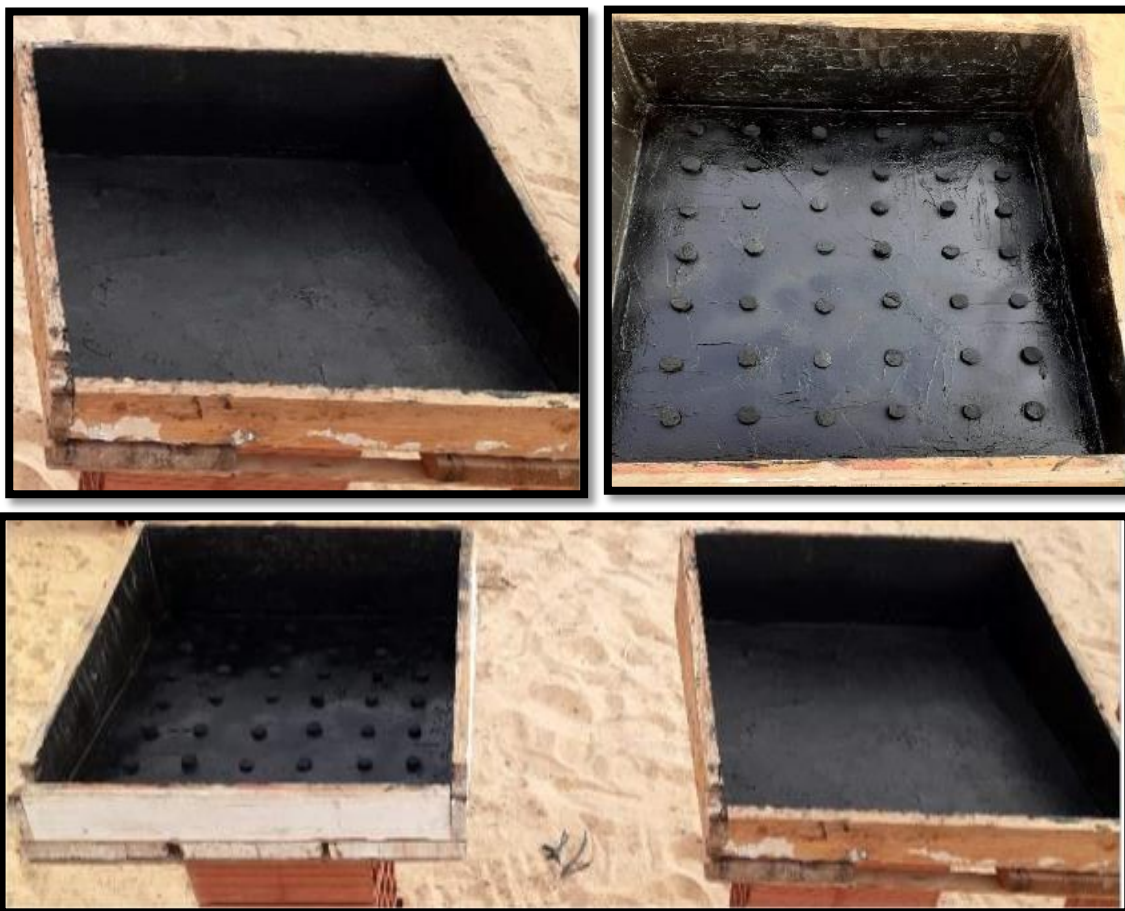
الشكل (10-3) : صورة توضيحية للمقطر الشمسي الشاهد والمحسن (أسطوانات الفحم).
