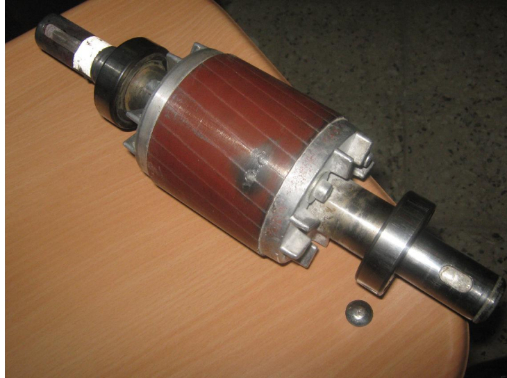
Figure III.11. Rotor du moteur 1.1 kW avec deux barres cassées [1]
