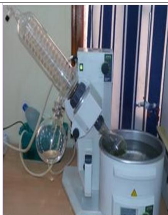
Evaporateur rotatif de type Buchi Rotavapor
