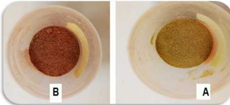
الشكل 6 : صورة لألياف نخيل التمر (A) قبل المعالجة و (B) بعد المعالجة بهيدروكسيد الصوديوم NaOH
