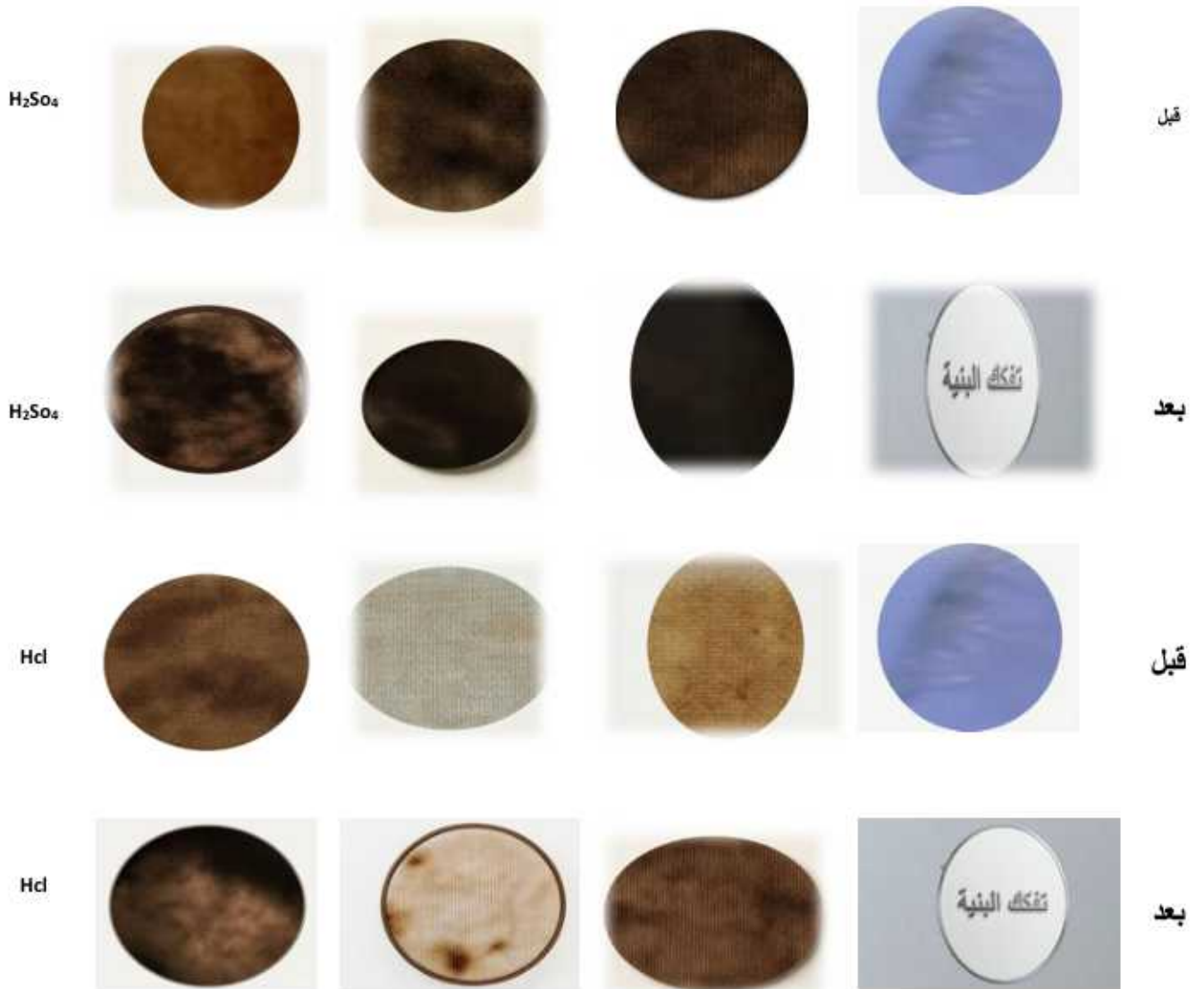
الشكل III. 6 : تمثيل بياني يوضح عينات من البوليمار في الأوساط الحامضية في H_2SO_4 و HCl
