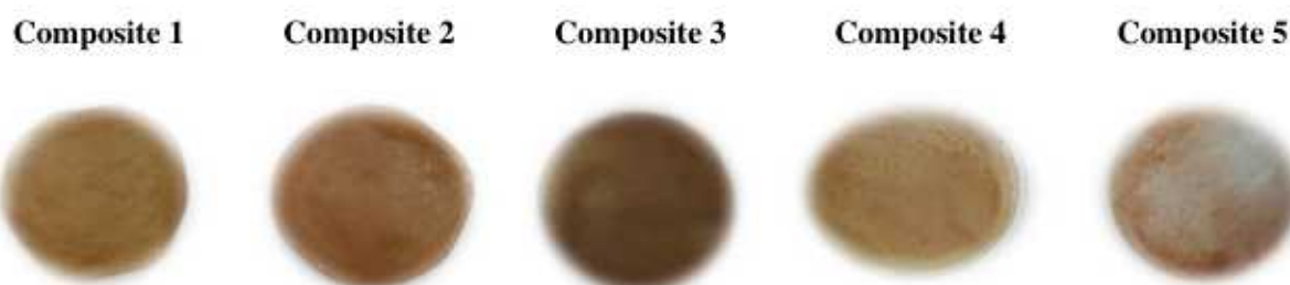
الشكل III. 8: صور نماذج لأغشية المركبات المحضرة
