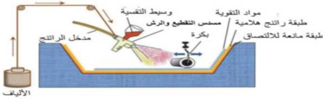
الشكل 11. 5: مخطط يوضح تقنية القالب المفتوح باستخدام مسدس الرش في تحضير المواد المركبة المدعمة بالألياف النباتية
