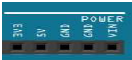
Figure II.7 : Porte de sorties électriques
