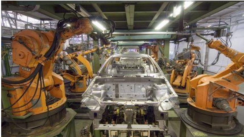
Figure I.7 : Assemblage de sous-ensembles soudés par robotisation en atelier de ferrage. [12]
