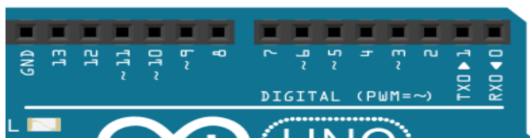
Figure II.6 : Porte Entrées /sorties numérique.
