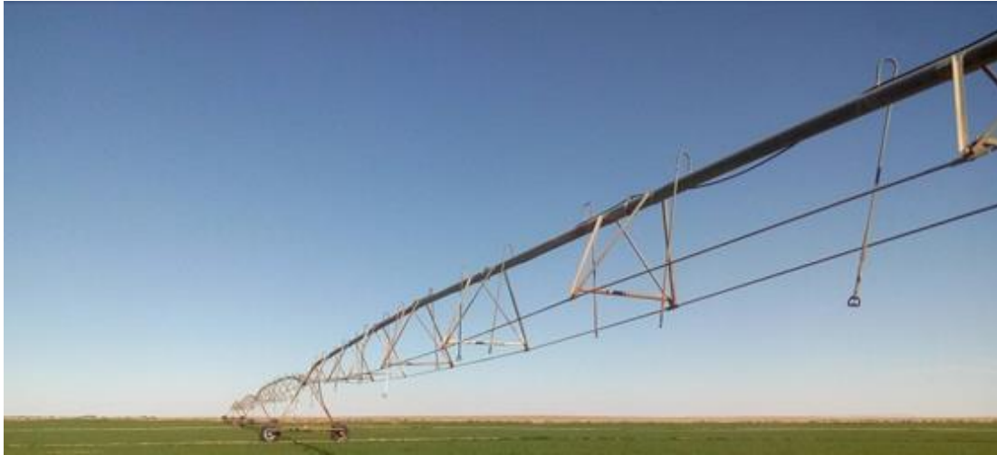
Figure I. 2: travée d'une ANABIB
