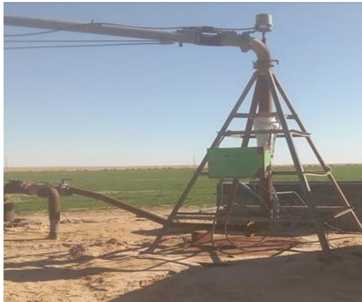
Figure I. 3 : Pivot d'une rampe
