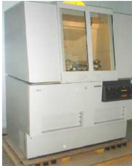
Figure III.5: Spectrophotomètre de fluorescence X (de type Philips, Magi XPRO)
