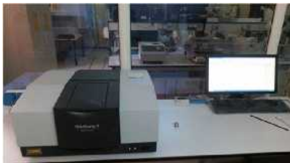
Figure III .1: Spectroscopie IR (de type SHIMADZN IR. INFINITY 1)
