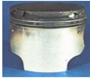
Fig.III.5 : Rupture du segment de feu.
