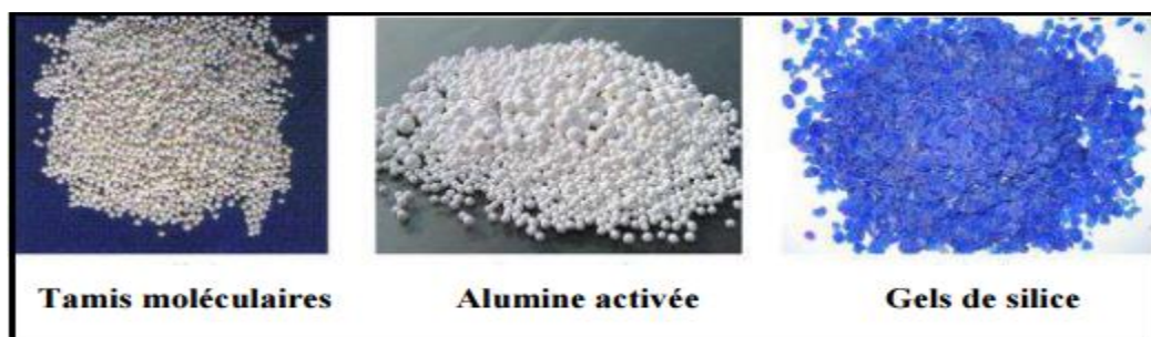
Figure III.20. Trois principaux types d'adsorbants solides.
