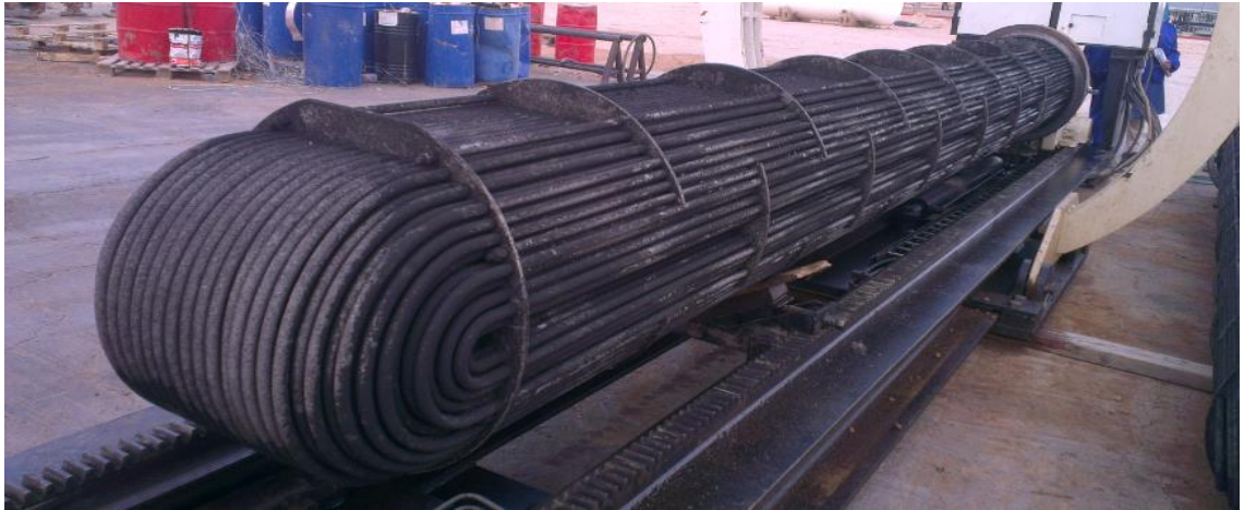
Figure V.5. Faisceaux des tubes.
