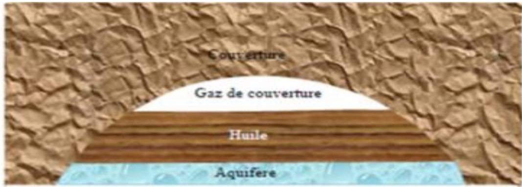
Figure II.9. Coupe schématique d'un gisement d'huile et de gaz associé [3].
