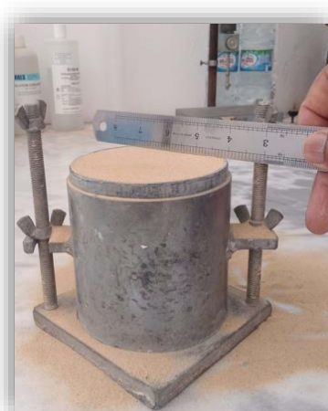
Figure II.17: Essais de la masse volumique apparente du sable de dune utilisé.
