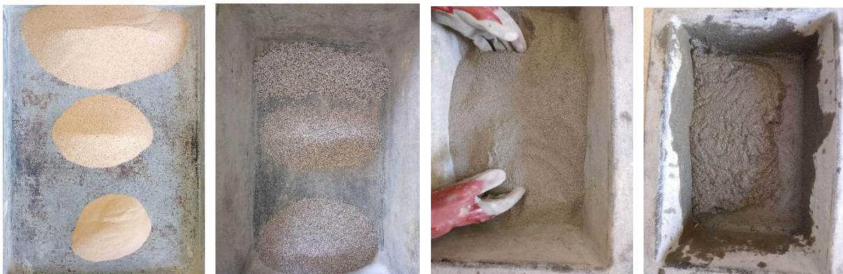
Figure II.28: Les étapes pour préparer la pâte de mortier avec différent pourcentage des compositions
