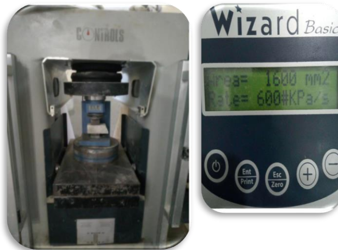
Figure II.40 : L'essai de résistance à la compression.
