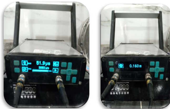
Figure II.42 Appareil à ultrasons (Proceq Pundit Lab).
