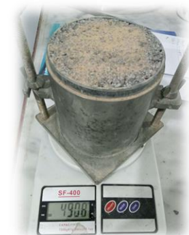
Figure II.20: Essais ( \rho_{apparent} ) du sable mélange.
