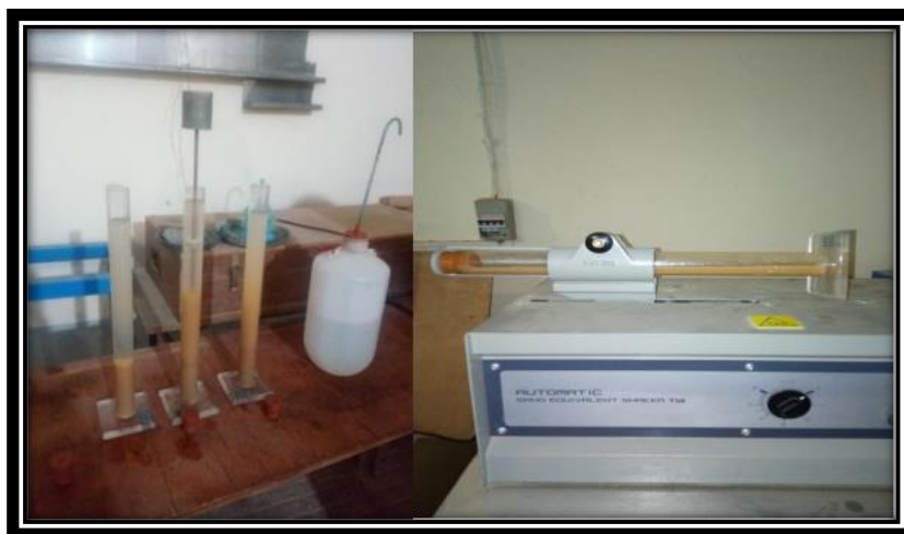
Figure II.25: Essai de l'équivalent du sable.
