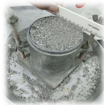
Figure II.19: Essais ( \rho_{apparent} ) du sable recyclé.
