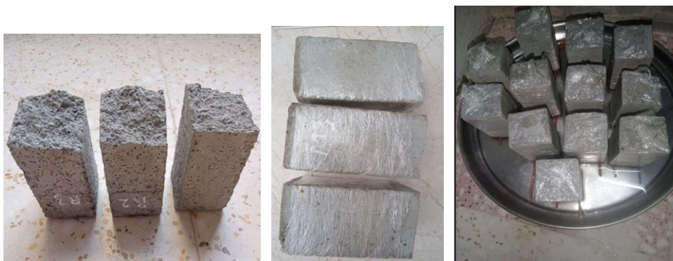
Figure II.35 : L'essai d'absorption par capillarité.
