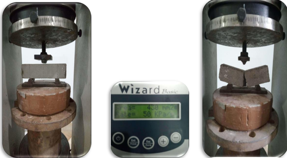
Figure II.39: L'essai de traction par flexion trois points.
