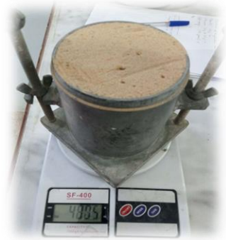
Figure II.18: Essais ( \rho_{apparent} ) du sable alluvionnaire.
