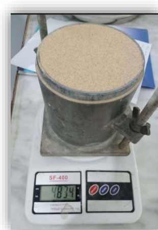
Figure II.17: Essais de la masse volumique apparente du sable de dune utilisé.
