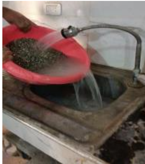
Figure II.26: lavage du granulat par l'eau
