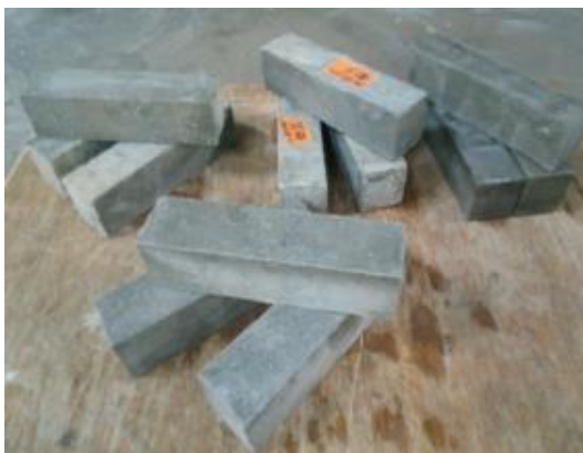
Figure II.32 : Prélèvement et étiquetage des éprouvettes.
