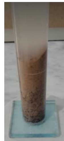
Figure II.24: Essais ( \rho_{\text{absolue}} ) du sable mélange.
