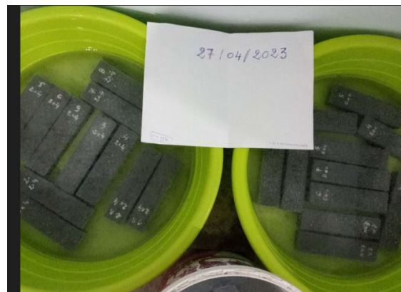
Figure II.33 : Cure des éprouvettes à l'eau pendant 7, 14, et 28 jours.
