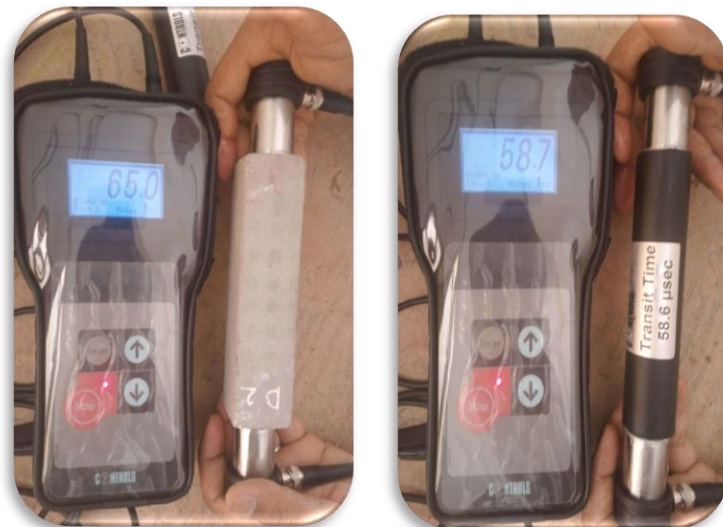
Figure II.43 Appareil à ultrasons (controls).
