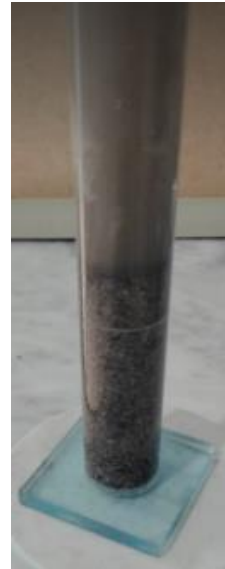
Figure II.23: Essais ( \rho_{\text{absolue}} ) du sable recyclé.
