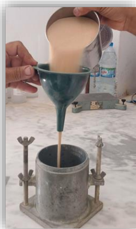
Figure II.17: Essais de la masse volumique apparente du sable de dune utilisé.
