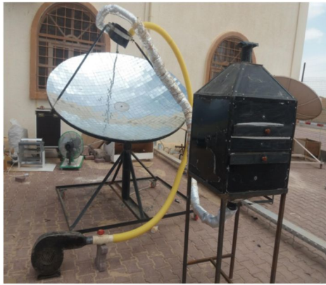
Figure.1 Séchoir solaire assisté par un concentrateur parabolique
