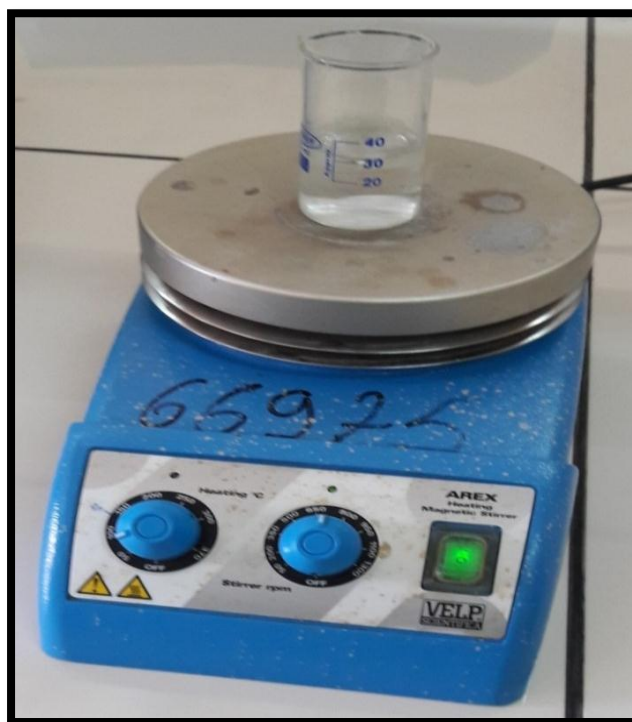
الشكل (3-II): عملية تحضير محلول كبريتيد الزنك (\text{ZnS}) .
