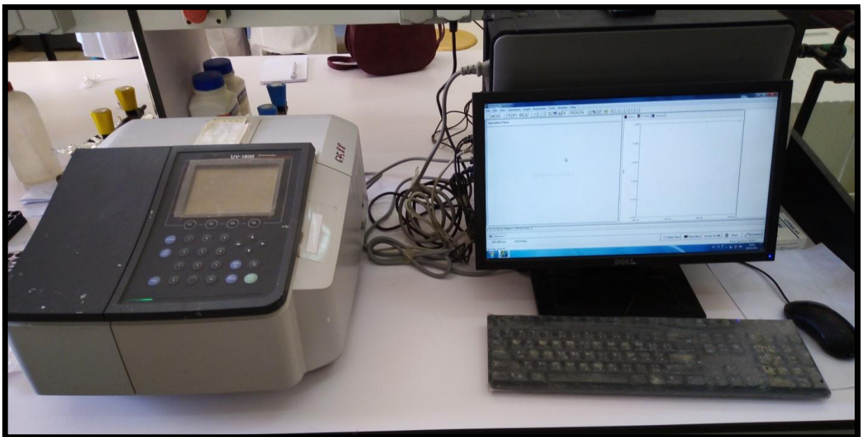
Annexe 6: Appareil de dosage protéine tissulaire (photo originale).
