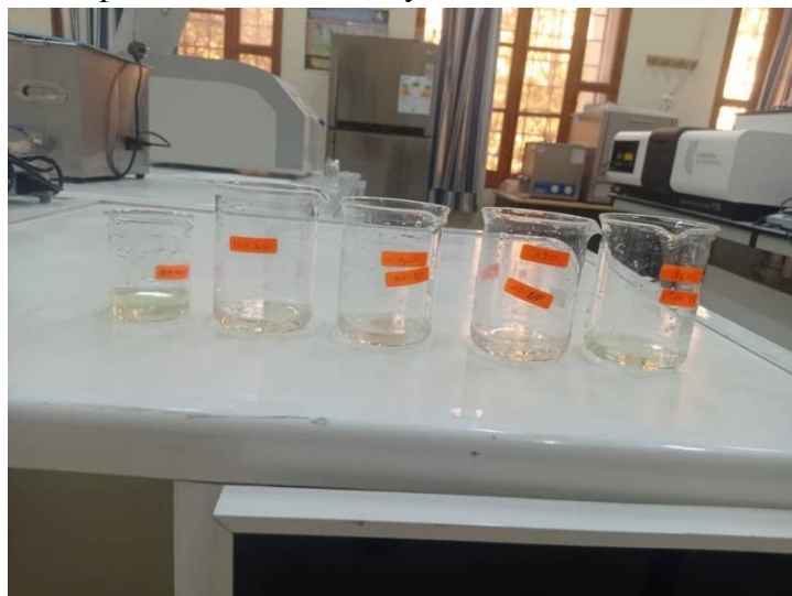
Figure(II.10): Échantillons d'effluents après traitement d'adsorption en fonction du temps de contact (Cinétique d'adsorption).
