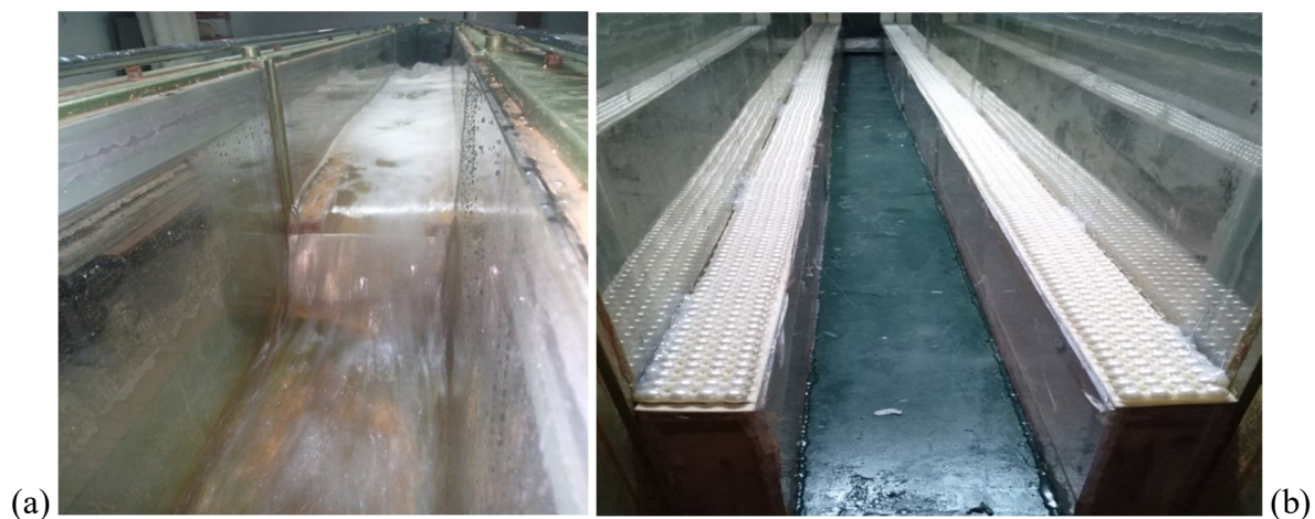
Figure 1.11: Les tapis rugueux imposés au lit majeur du canal composé.
