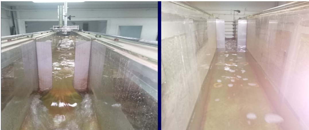
Figure 1.5: Le déversoir rectangulaire avec contraction latérale pour mesurer les débits pompés.
