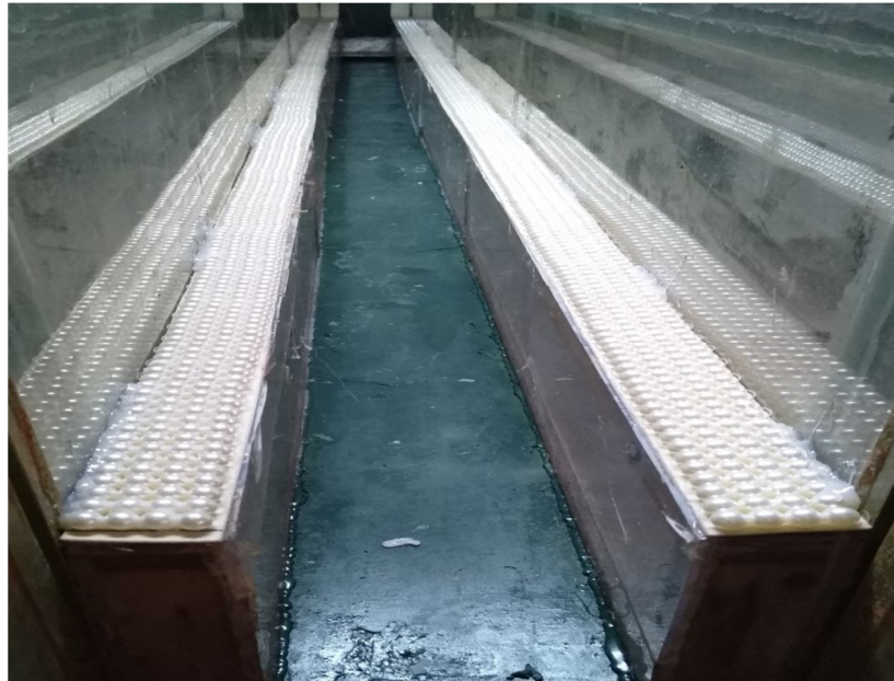
Fig. 2.4. Photographie d'un tapis rugueux soigneusement collé sur le lit majeur du canal rectangulaire de section composée.
