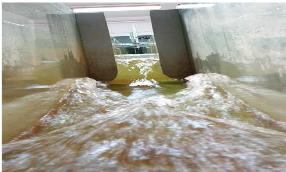
Fig 2.3. Déversoir rectangulaire utilisé aux mesures des lames déversantes.
