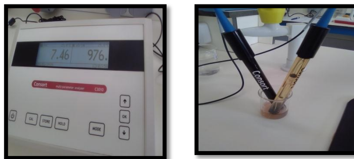
Fig. 31 : Mesurée le pH de jus des dattes et de noyau par le pH-mètre
