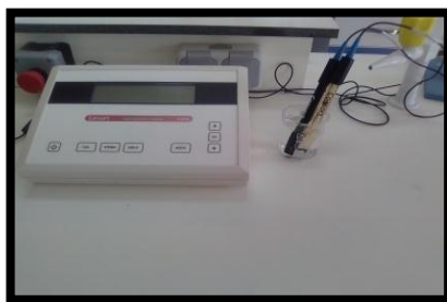
Fig. 30 : Mesurée la teneur de CE par le de conductivité électrique
