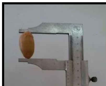
Fig. 28 : Mesurée le poids de datte et la longueur par la balance et pied de mère
