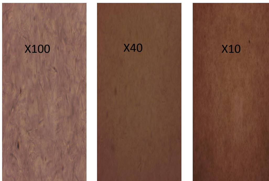
الوثيقة 34. صورة بالمجهر الضوئي للمرهم المرطب تبين مدى التجانس.
