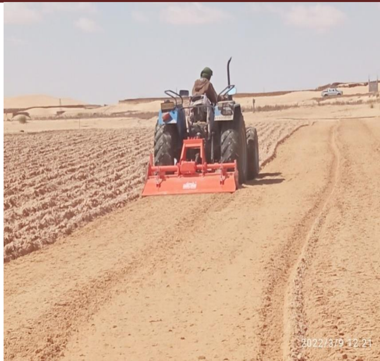
Figure 16: - l- préparation du lit de semence et nivellement de parcelle avec le rotavator.
