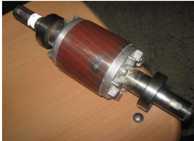
Figure( II. 12): le rotor du moteur avec 2 barres cassées
