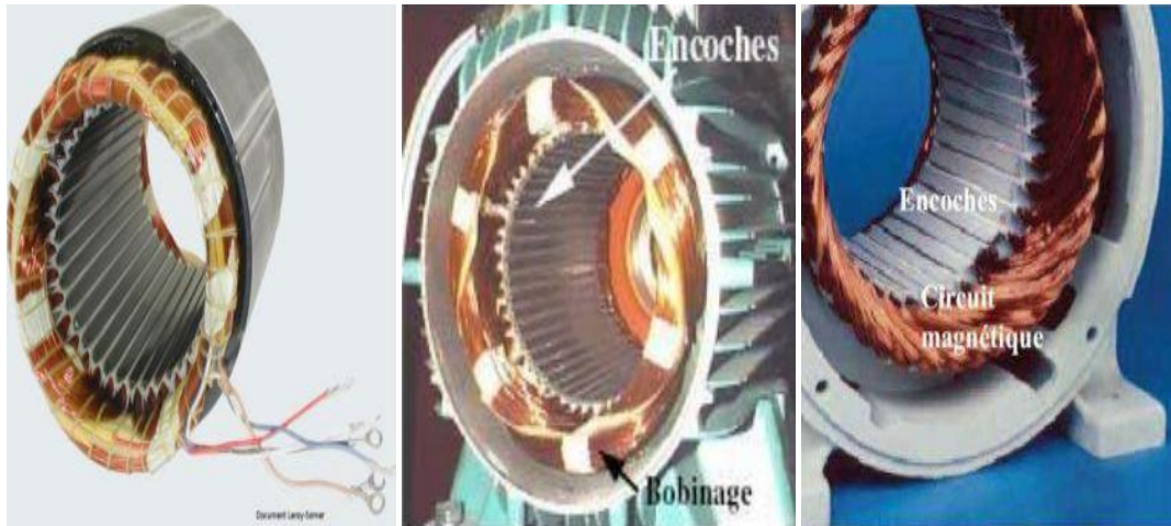
Figure(I. 2 ):Photo du stator d'une machine asynchrone.
