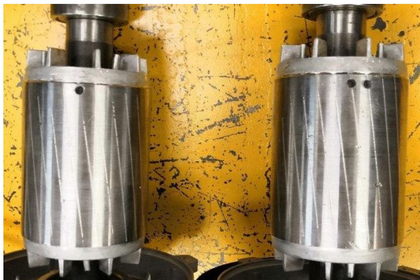
Figure (III.2): Photographie des rotors de la MAS de 3 kW pour une barre cassée (gauche) et avec deux barres cassées (droite).
