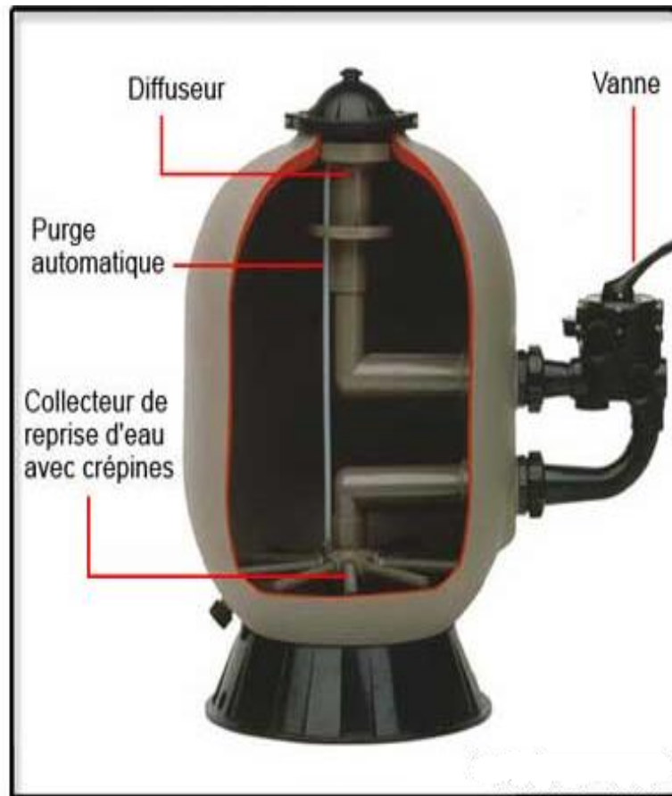
Figure IV.4 La Filtre à Sable
