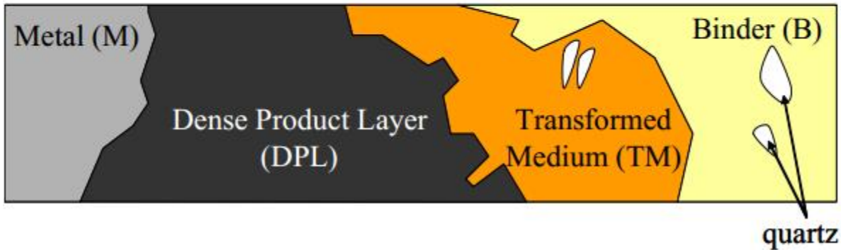
الشكل II.24 يوضح مختلف الطبقات المحيطة بالتسليح داخل الخرسانة المنهارة [61]
