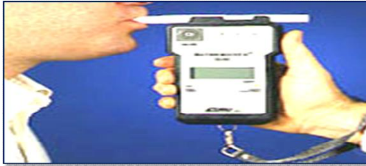
الشكل (02) يبين كيفية استخدام جهاز قياس الكحول 3 .
