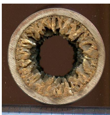
Figure 1.2 : Dépôts de \text{CaSO}_4 dans une pipe de pétrole [12].
