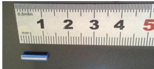
Figure III.1 : Électrode de travail utilisée choisi pour l'étude de déposition.
