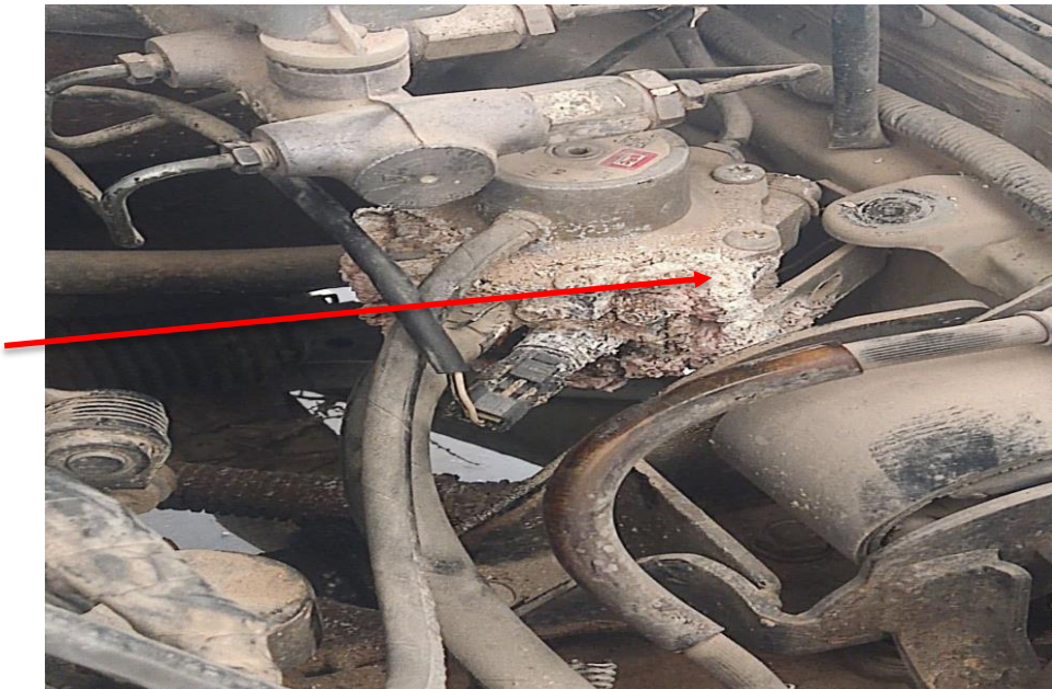
Fig.IV.2.1.1.2. Fuite le détendeur
