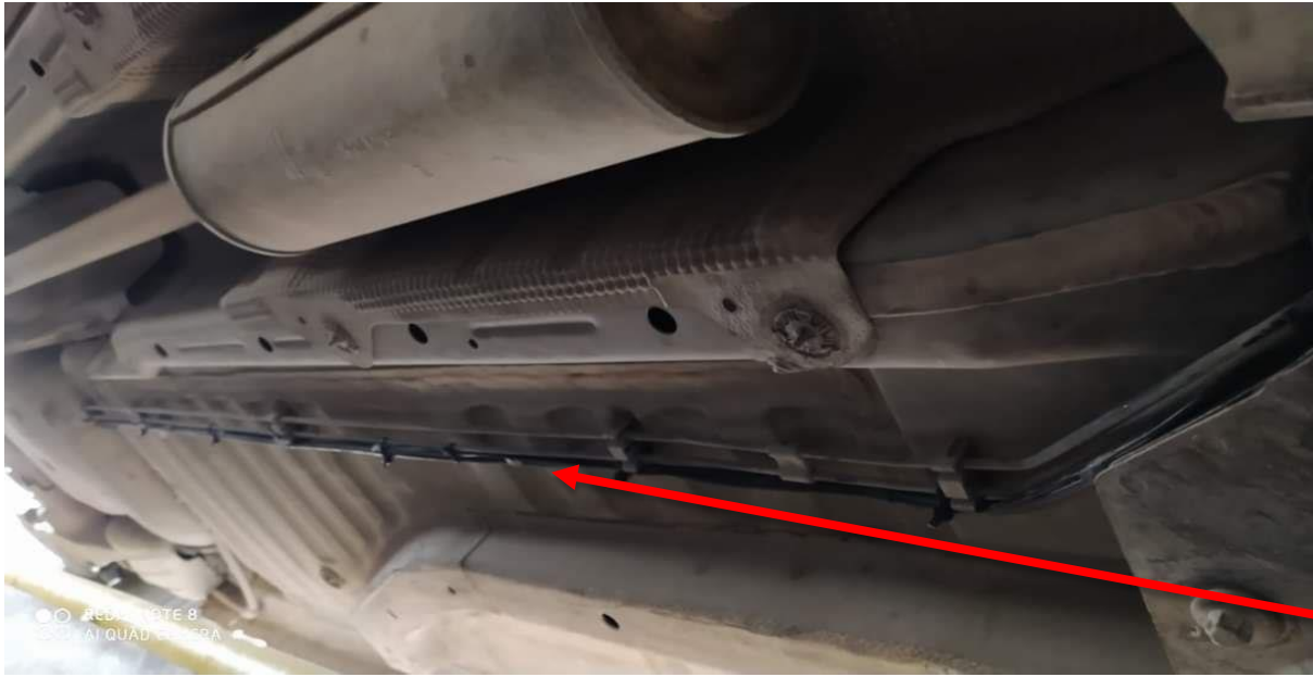
Fig.IV.1.10. Conduites de gaz du réservoir
