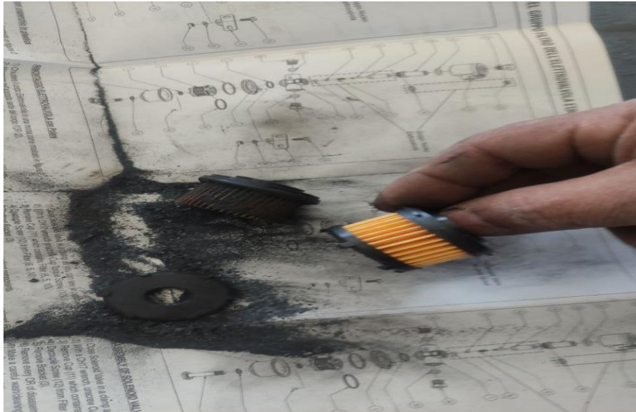
Fig.IV.2.1.1.1. Différence entre le filter neuf et l'ancien
