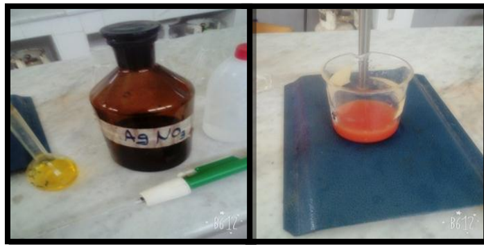
Figure 10 : Dosage du chlorure.
