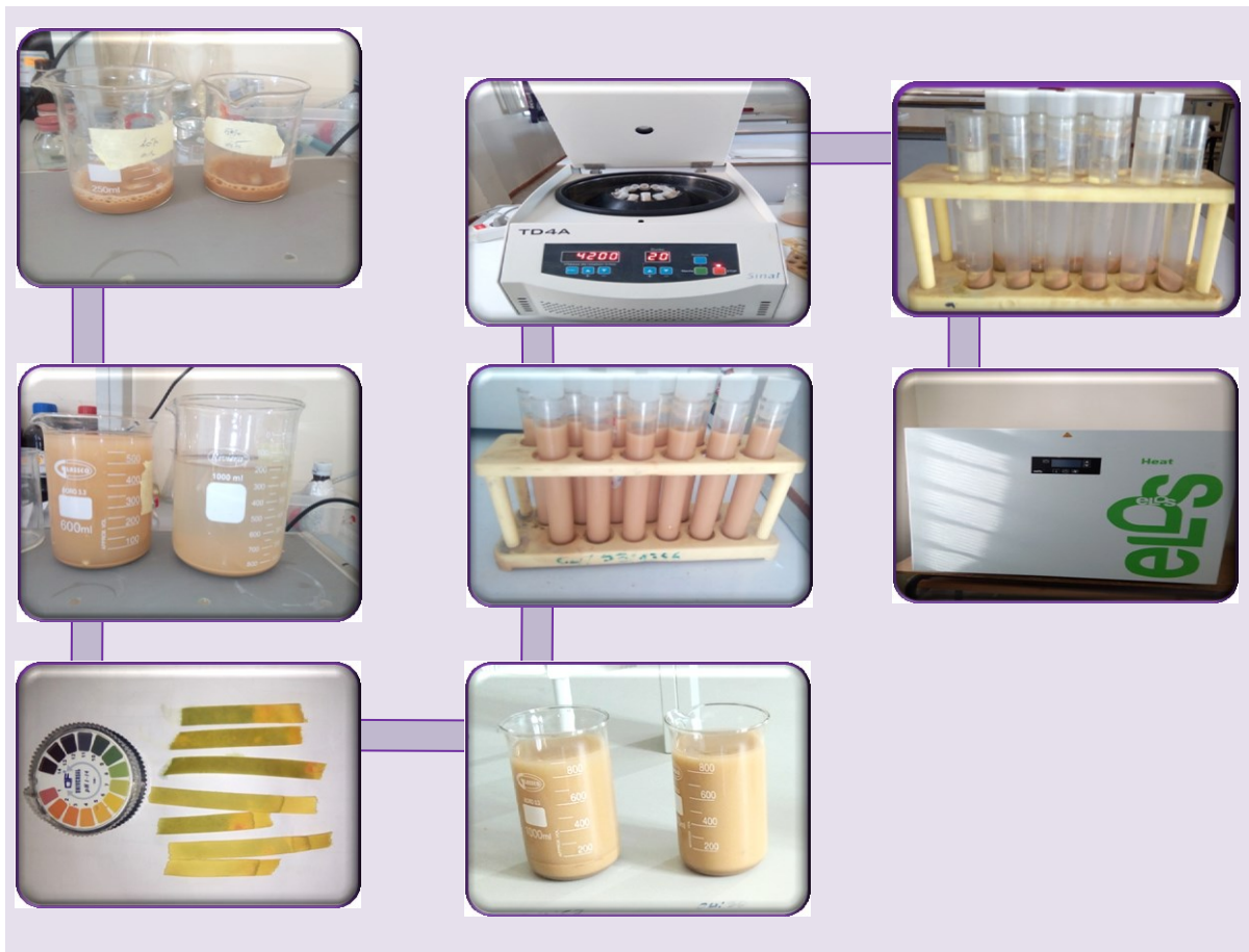
Figure IV.5 Organigramme du l'activation par hydroxyde de sodium
