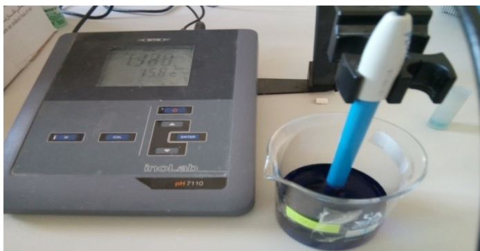
Figure IV.14 : Détermination des valeurs pH par pH -mètre type AcroLab 7160
