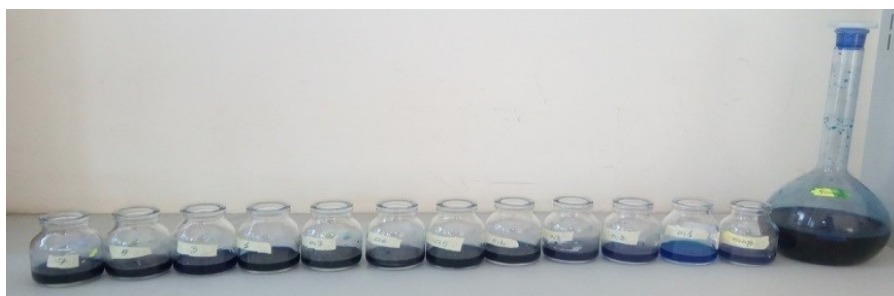
Figure IV.8 : Solutions diluées de BM pour tracer la courbe d'étalonnage
