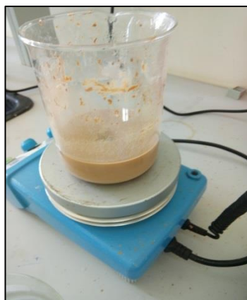
Figure : le traitement par solution d'acide chlorhydrique HCl
