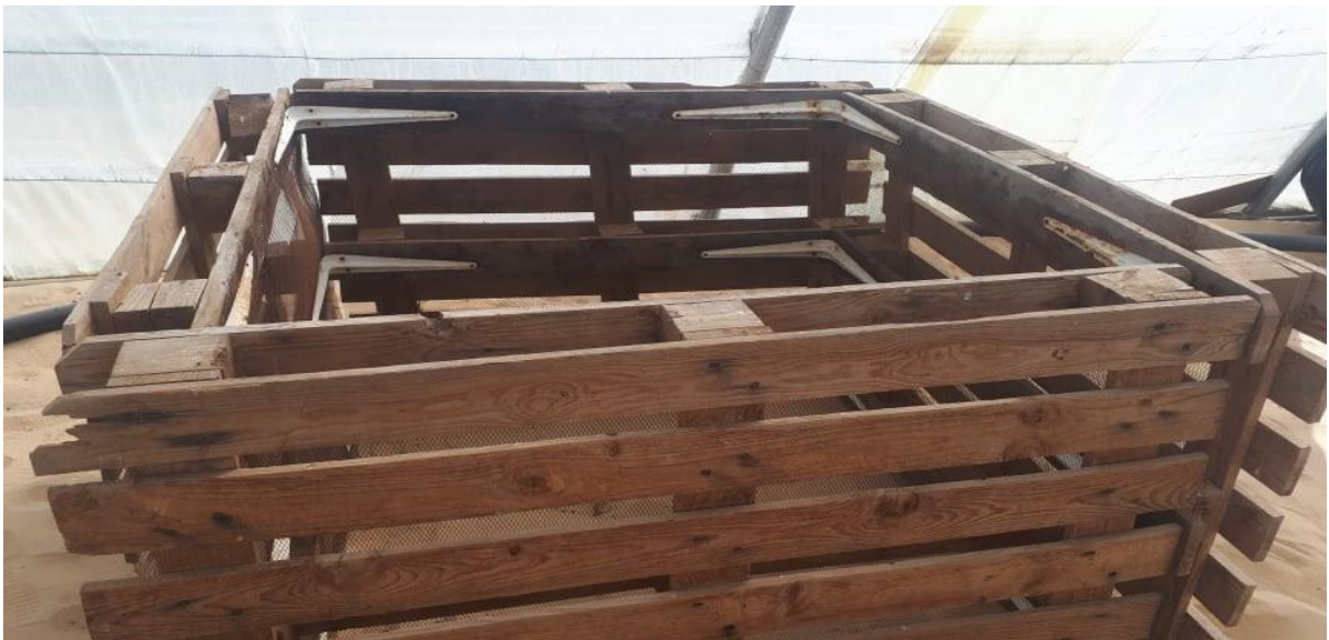
Figure 04 : Composteur utilisé dans la préparation de compost des DMA mélange (photo personnel).
