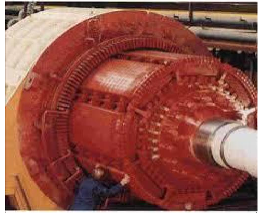
Fig.I.11. Turbo ALT d'une centrale électrique
