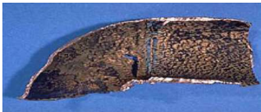
Figure I.9 : Étapes de développement du phénomène de corrosion-érosion [28].
