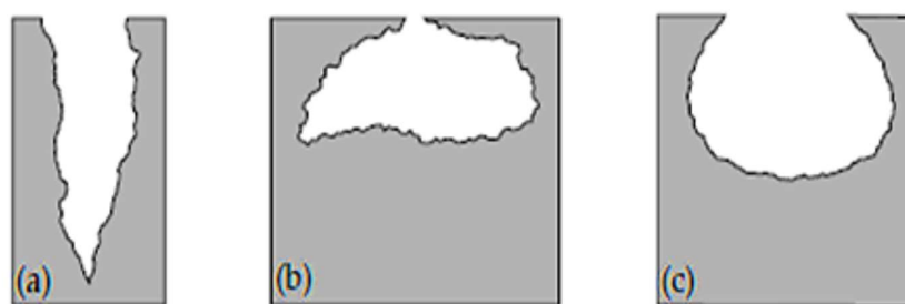
Figure I.5 : Formes de piqûres (a) cavité profonde (b) cavité cavernueuse (c) hémisphérique [36].
