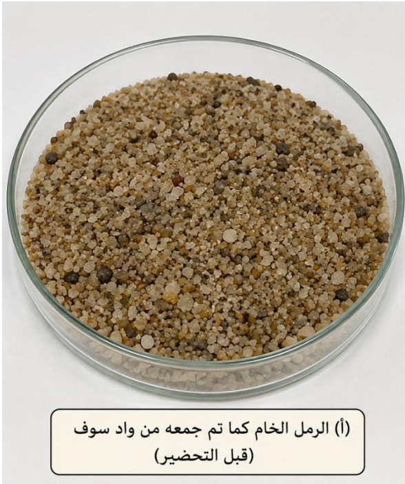
الشكل (2-2): رمل واد سوف المستعمل كمادة مازة طبيعية قبل وبعد التحضير.
