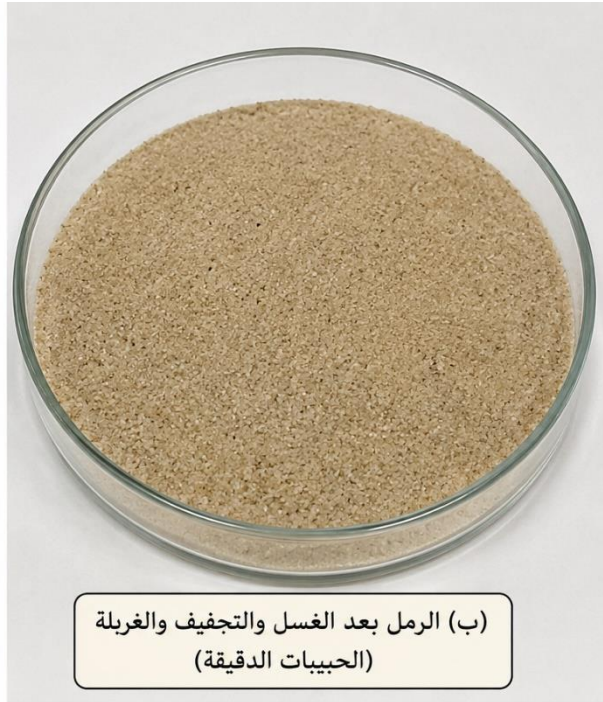
الشكل (2-2): رمل واد سوف المستعمل كمادة مازة طبيعية قبل وبعد التحضير.
