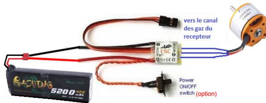
Figure 32: brochage électrique d'un ESC
