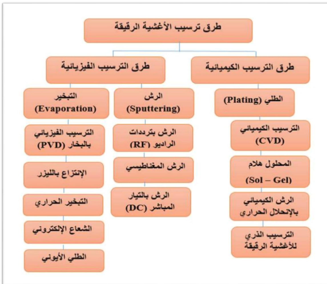
الشكل (4.2): مخطط يوضح التقنيات المختلفة لترسيب الأغشية الرقيقة [2].
